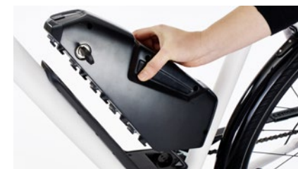
dot. pkt 1. Przytrzymać przy stacji dokującej
