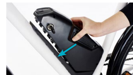
dot. pkt 2. Akumulator docisnąć do stacji dokującej
