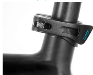
dot. pkt 2. Zamknięta dźwignia zacisku szybko mocującego
