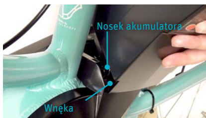
dot. pkt 2. Nosek akumulatora we wnęcie
