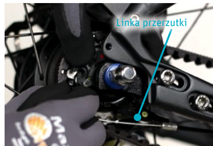
dot. pkt 3. Odłączyć linkę przerzutki od koła tylnego
