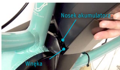
dot. pkt 2. Nosek akumulatora we wnęcie
