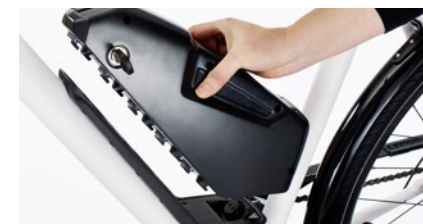
dot. pkt 1. Przytrzymać przy stacji dokującej
