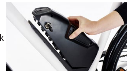
dot. pkt 2. Akumulator docisnąć do stacji dokującej
