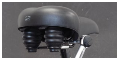
dot. pkt 1. Poluzować nakrętkę zaciskową
