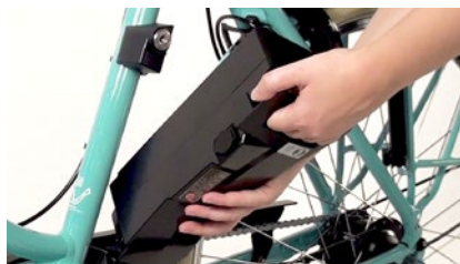
dot. pkt 1. Przytrzymać przed stacją dokującą
