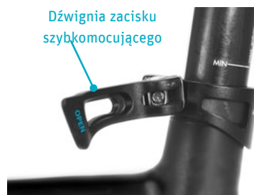
dot. pkt 1. Otworzyć dźwignię zacisku szybko mocującego.
