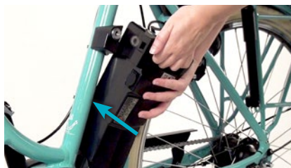
dot. pkt 3. Akumulator wsunąć do stacji dokującej
