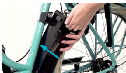
dot. pkt 3. Akumulator wsunąć do stacji dokującej
